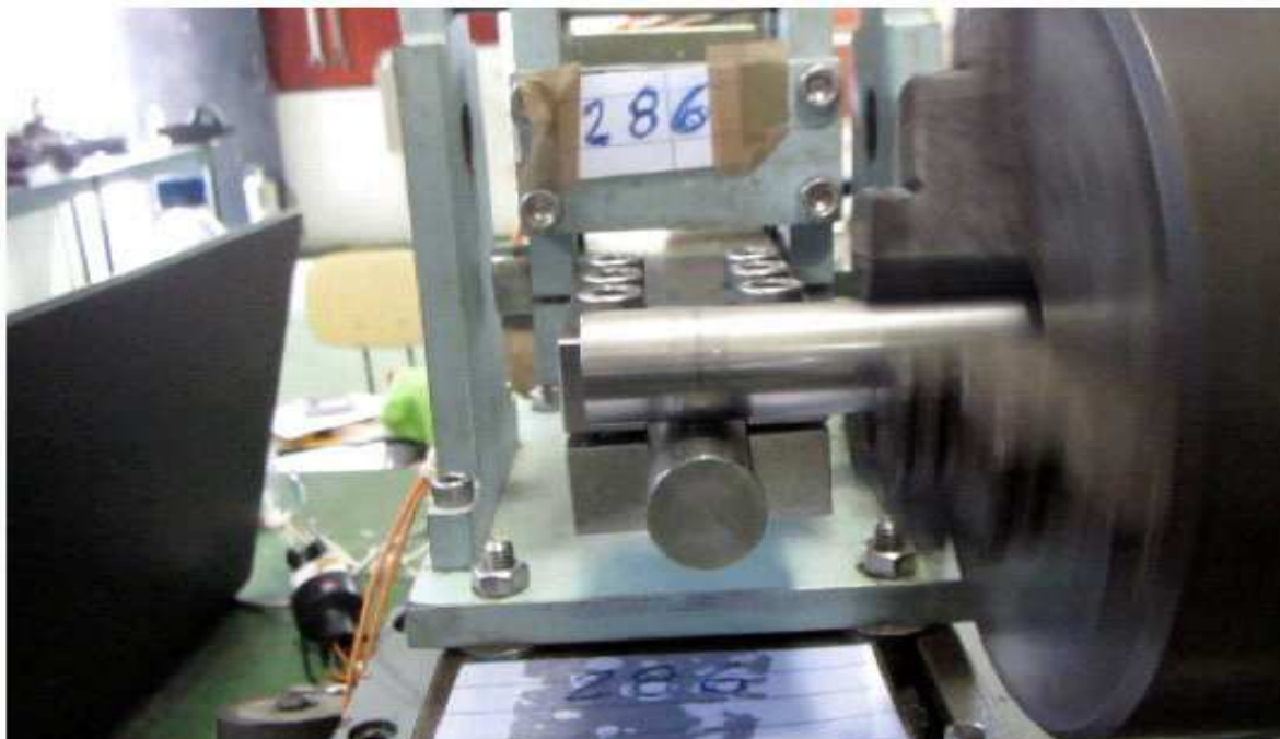
Figura 2. Vemos el arreglo de las muestras y su geometría espacial, la cual permite formular las funciones que posteriormente se van a usar en la evaluación de los resultados experimentales, como en la figura. Los especímenes son cilíndricos, de superficie pulida de acero inoxidable (endurecido o sobre endurecido). También el siguiente arreglo, el parámetro d1 , determina experimentalmente la relación de desgaste.
